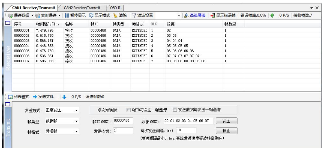
图 12-1 CAN 分析仪上位机接收状态
